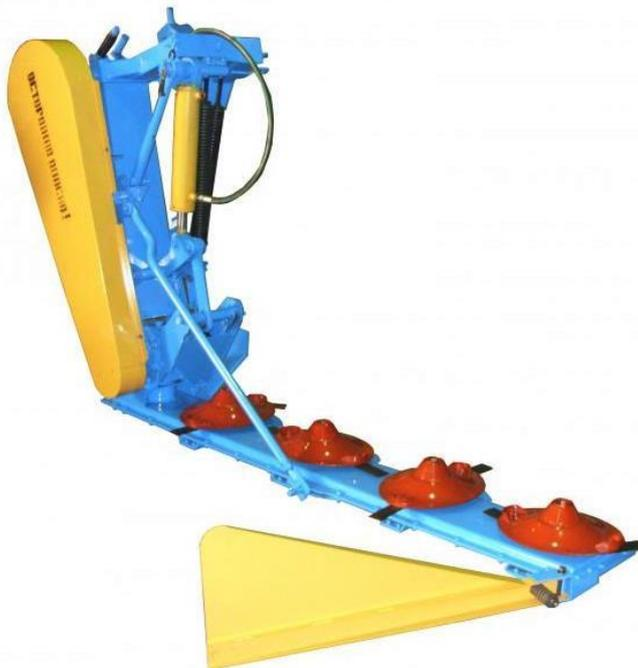
Предназначена для скашивания сеянных и естественных трав в агрегате с трактором типа МТЗ (классов 0,9 и 1,4) на повышенных поступательных скоростях с укладкой скошенной массы в прокос.
