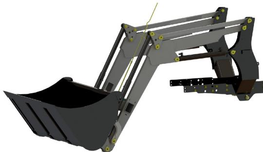
**Назначение:** погрузка различных сельско-хозяйственных грузов (минеральных удобрений, песка и т.п.) в транспортные средства, перевозка и укладка рулонов сена, а также дорожно-строительные работы, уборка и погрузка снега, выполнение легких планировочных работ.
