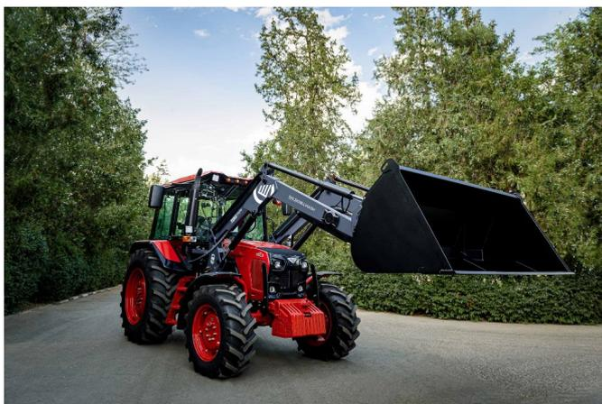
Фронтальный погрузчик TURS-1500М является самым универсальным рабочим инструментом в модельном ряду TURS. Благодаря увеличенной до 1700кг грузоподъемности и наибольшей во всей линейке высоте до оси вращения рабочего органа, равной 4,04м, этот погрузчик обладает самым лучшим соотношением цены и получаемых технических возможностей. Богатая базовая комплектация делает его незаменимым помощником в любом хозяйстве и включает в себя:
