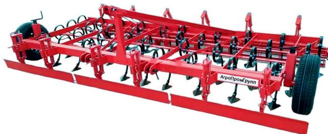
**Назначение:** предпосевная подготовка почвы и обработки паров. Культиватор представляет собой систему, состоящую из бруса с присоединенными к нему шасси, выравнивателей, рамы с рабочими органами и катками. Выравниватель устанавливается перед рабочими органами для уменьшения гребнистости поля образованной предыдущими обработками. Конструкция выравнивателя позволяет изменять угол наклона экрана и глубину обработки.
